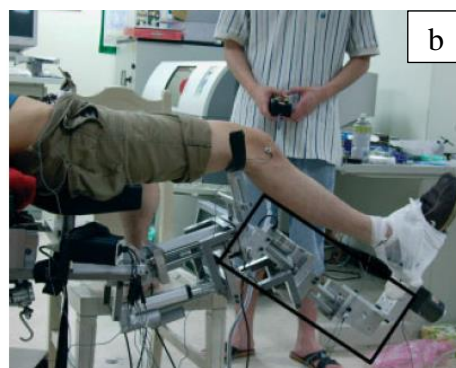
Рисунок 11. Эксперимент в лабораторных условиях с использованием робота для репозиции: а) сгибание колена; б) тракция конечности. (Figure 11. An experiment in laboratory conditions using a robot for repositioning: a) knee flexion; (b) traction of the limb).
