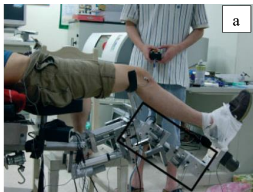
Рисунок 11. Эксперимент в лабораторных условиях с использованием робота для репозиции: а) сгибание колена; б) тракция конечности. (Figure 11. An experiment in laboratory conditions using a robot for repositioning: a) knee flexion; (b) traction of the limb).
