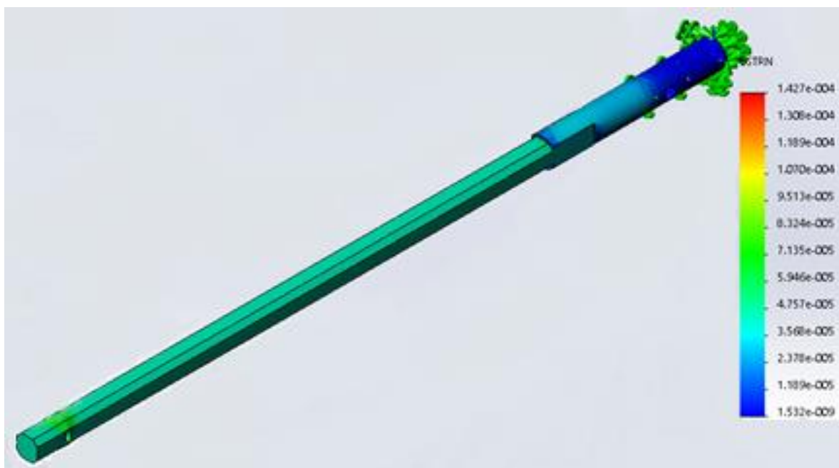
Рисунок 8. Распределение эквивалентных деформаций в образце 1.
