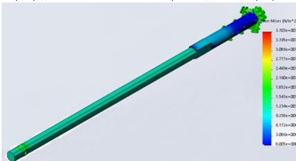
Рисунок 4. Распределение эквивалентных напряжений в образце 1.
