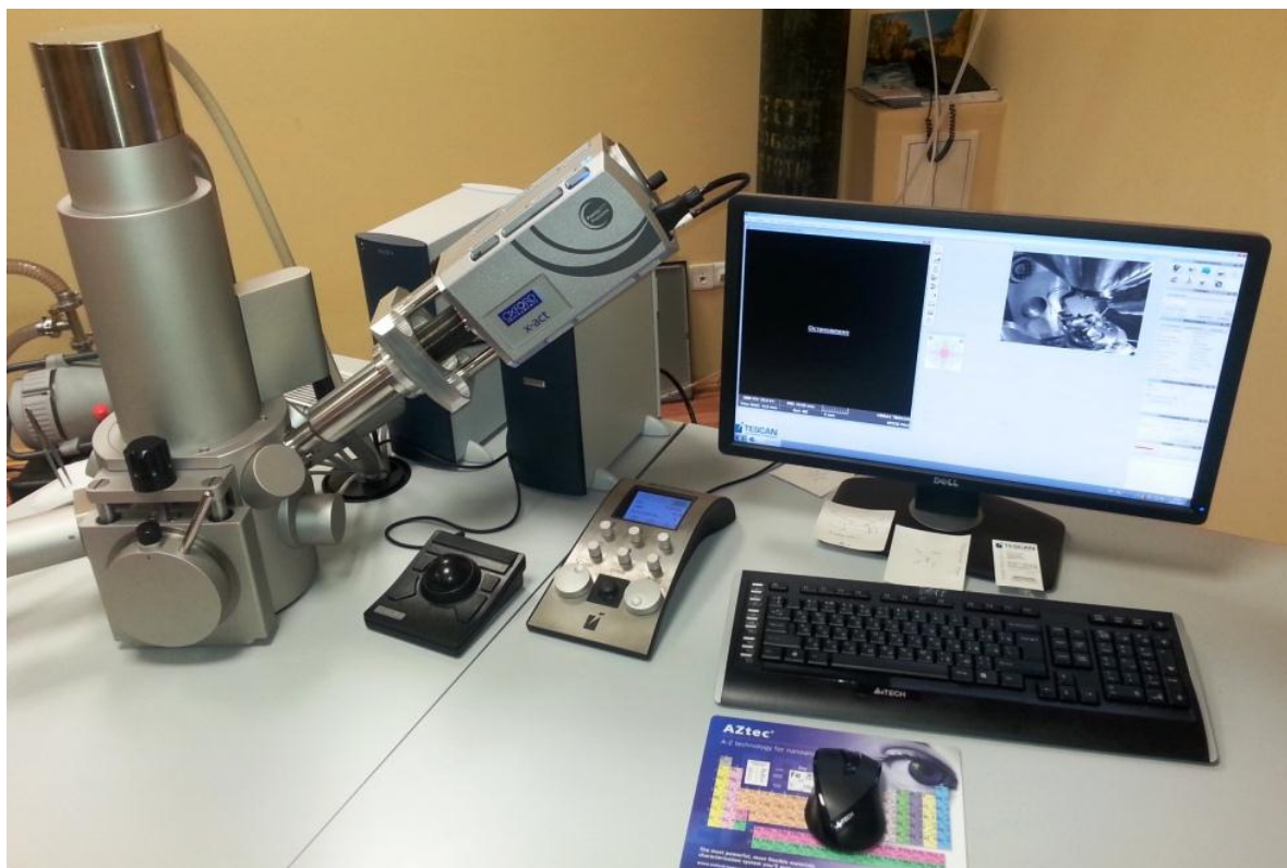
Рисунок 1. Сканирующий растровый электронный микроскоп «Tescan VEGA 3 SBH», управляемый через персональный компьютер.
