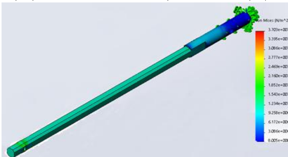
Рисунок 4. Распределение эквивалентных напряжений в образце 1.
