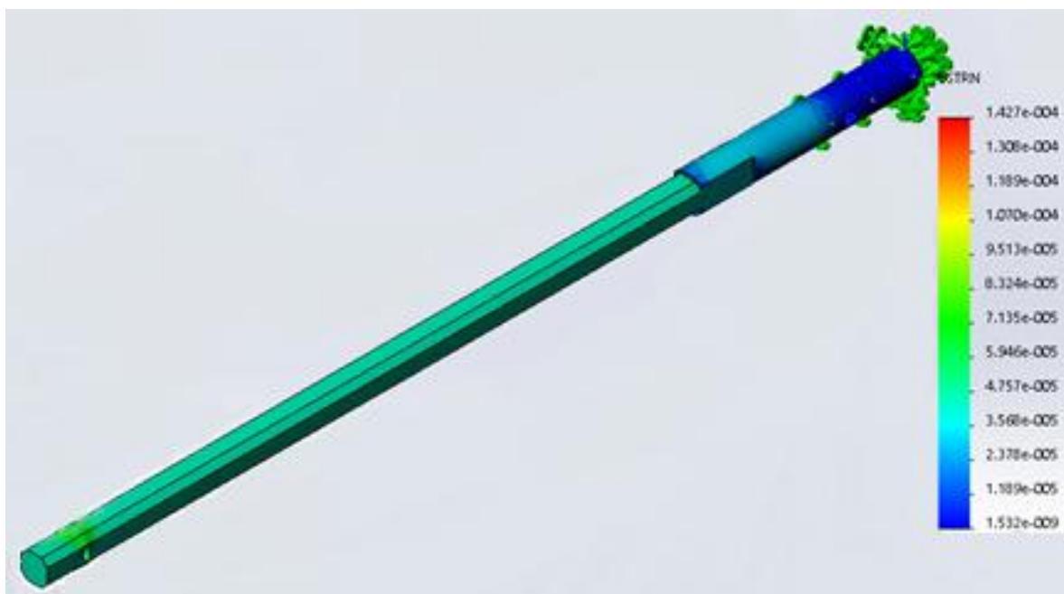
Рисунок 8. Распределение эквивалентных деформаций в образце 1.
